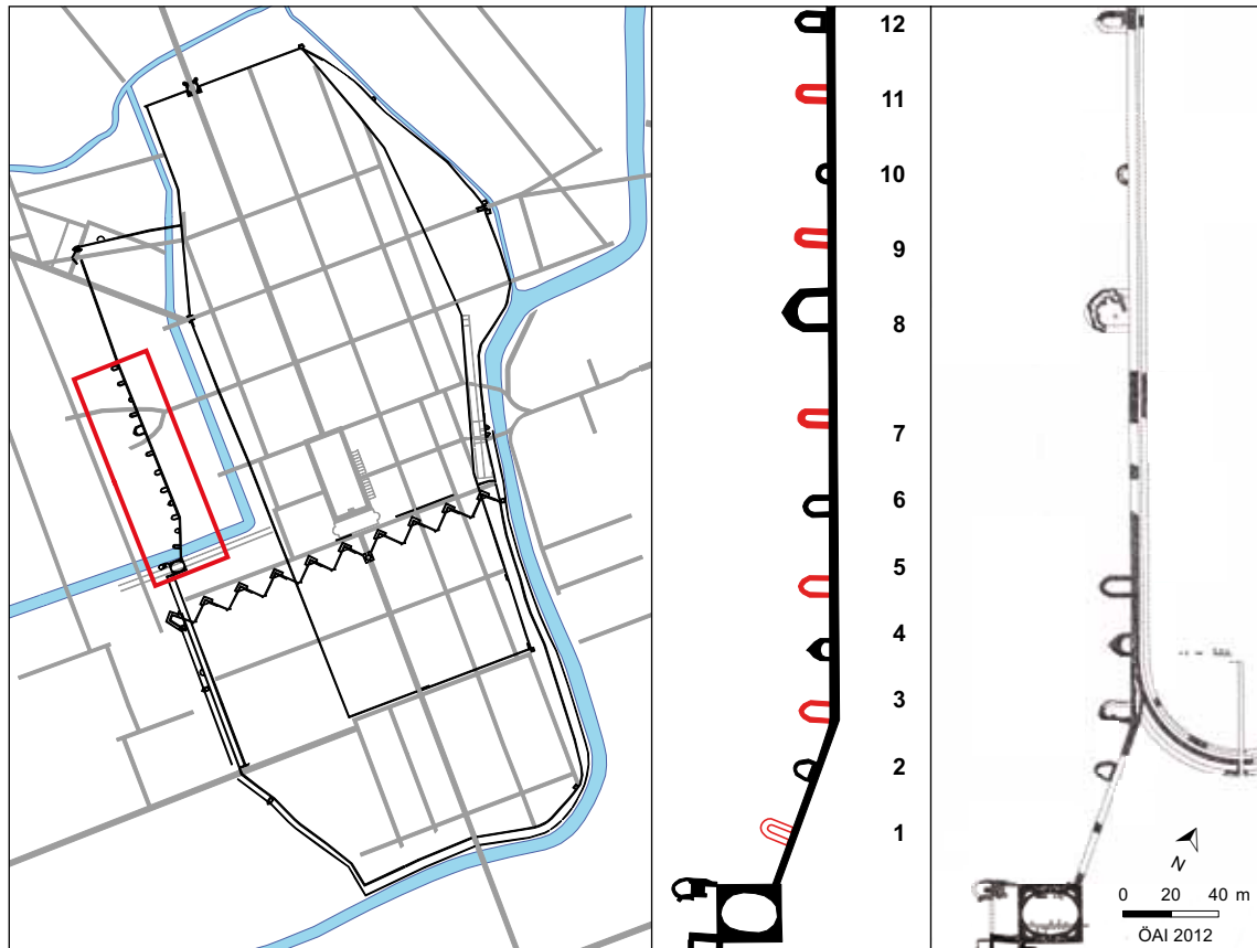
11 Die Stadtmauer M2 im Westteil von Aquileia: Sequenz U-förmiger (rot) und halbrunder/pentagonaler Türme (schwarz) (Geophysik 2001) sowie Grabungsbefunde
